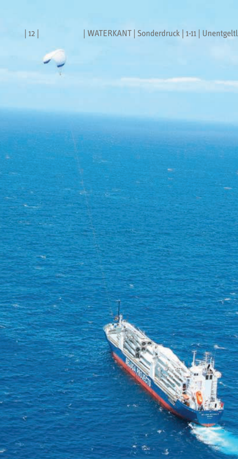
Eines von Stolbergs Vorzeigeprojekten war die »Beluga Skysails« mit Zugdrachen-Antriebsunterstützung – eines der wenigen Schiffe seines Unternehmens unter deutscher Flagge.
